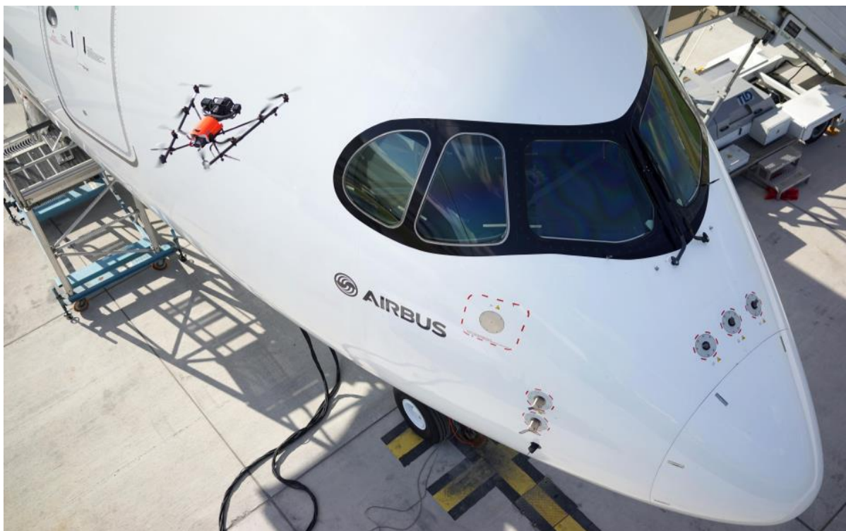
Inspection qualité d'un A350 XWB par drone
